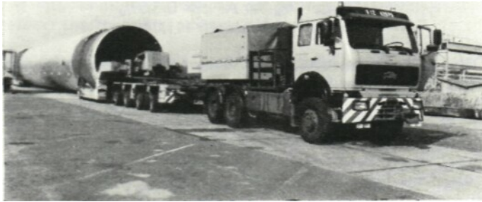
Transport von 20 m langen, 40 Tonnen schweren Spezialelementen für Rauchgasanlage Salzgitter BRD
