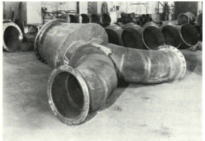
Halle IV Werk II Segmentkrümmertfergung
